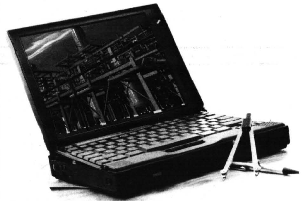
Na zdjęciu jeden z najnowocześniejszych notebooków produkcji IBM ThinkPad 760ED posiadający kolorowy wyświetlacz LCD o przekątnej 13,3 cala z matrycą aktywną.
