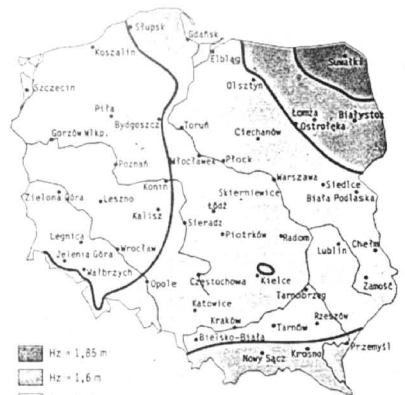
2. Wymagana głębokość zagłębienia przewodów wodociągu i kanalizacji
