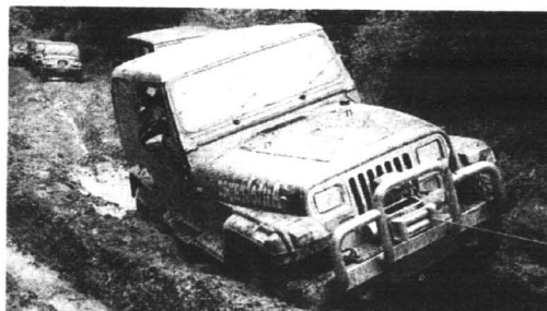
Wyciągarka o uciagu około 8 ton pozwala wydostać się z takich opresji. Trzeba tylko znaleźć w pobliżu dość solidne drzewo i zaczepić na nim koniec liny
