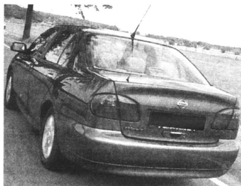
Nissan primera elegance 2.0 CVT z automatyczną skrzynią biegów, to pojazd XXI wieku. Skrzynia biegów posiada stałozmienne przełożeń, które pozwalają jeździć płynnie zawsze na jednym biegu
