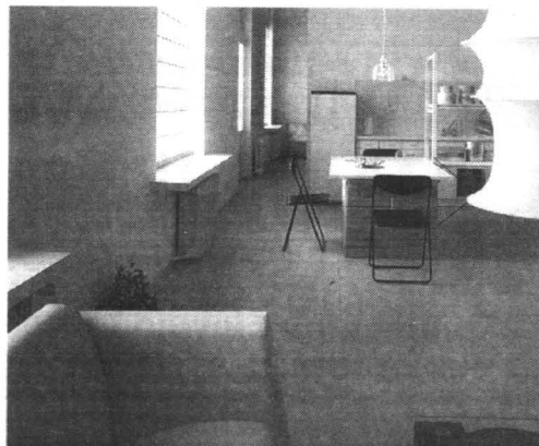
Cztery okna z luksferów uratowały światło wielkiej witrynie. Zapewniły też intymność, bo nie widać przez nie przechodniów, a z zewnątrz tego, co dzieje się w środku, czyli także w części kuchennej
