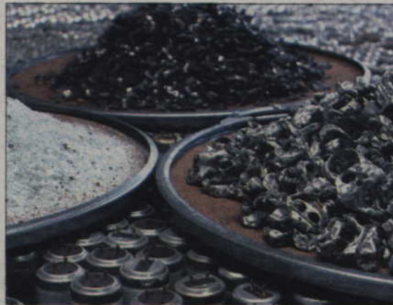
To rozebrane na części świetlówki, z których można ponownie użyć większość surowców, z których były wykonane.
