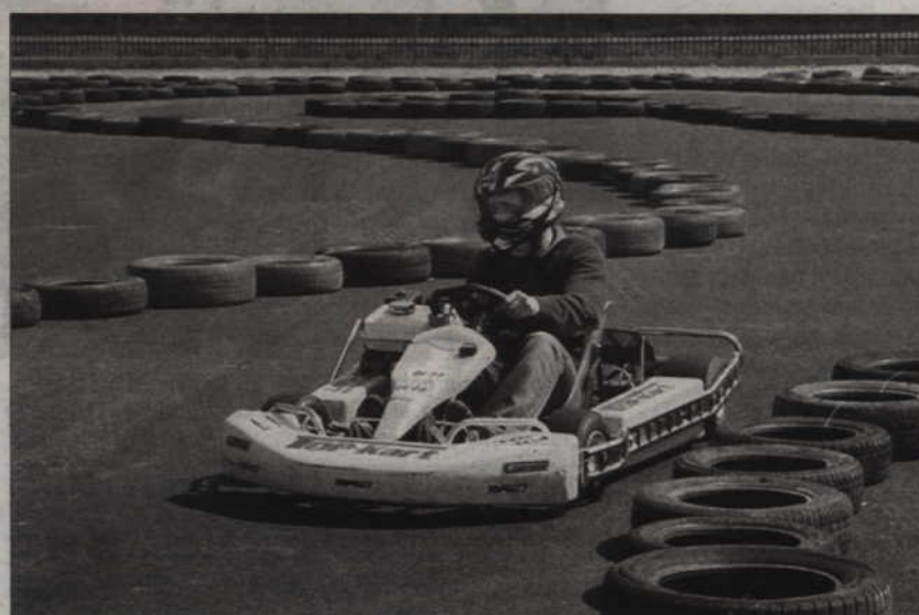
Gokarty budowano dawniej podczas zajęć w Technikum Samochodowym w Prabutach. Konstrukcja takiego pojazdu, wyposażonego w silnik motocykla WSK, nie była zbyt skomplikowana.
