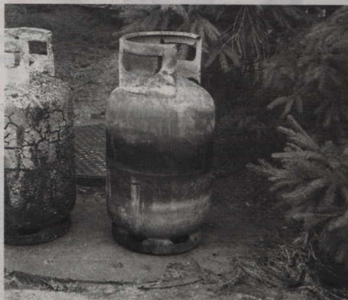
Wybuch spowodowała znajdująca się w kuchni nieszczelna butla z gazem propan-butan.
