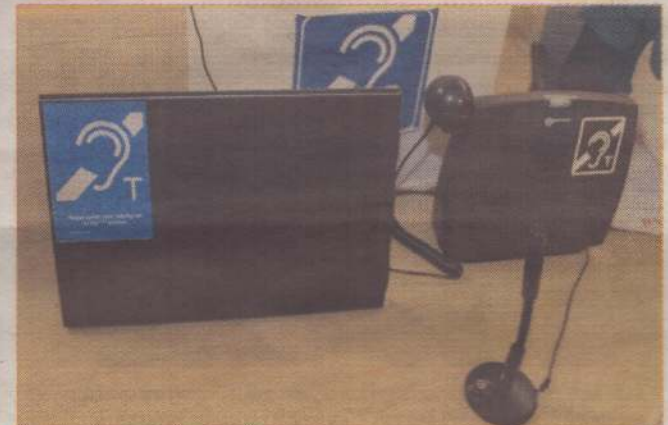
W Izbie Przyjęć pojawiły się urządzenia ułatwiające kontakt z osobami niedoświadczającymi. Pętla indukcyjna pozwala na przesyłanie dźwięku bezpośrednio do aparatu słuchowego.
